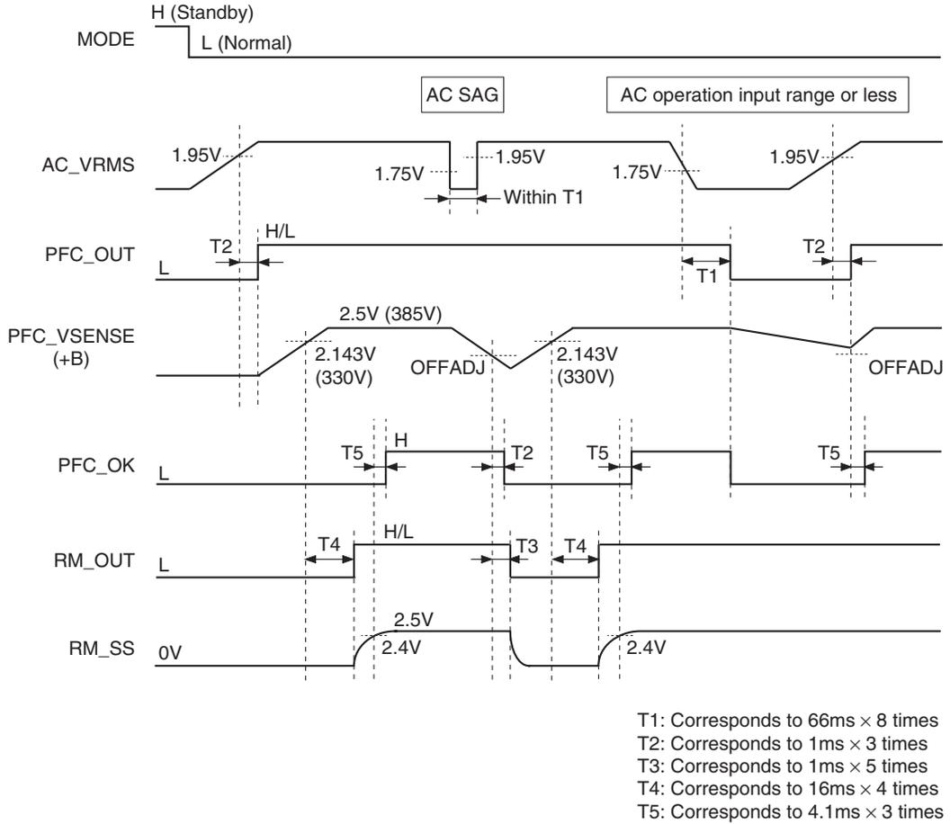
Fig. 21. Startup Waveform
